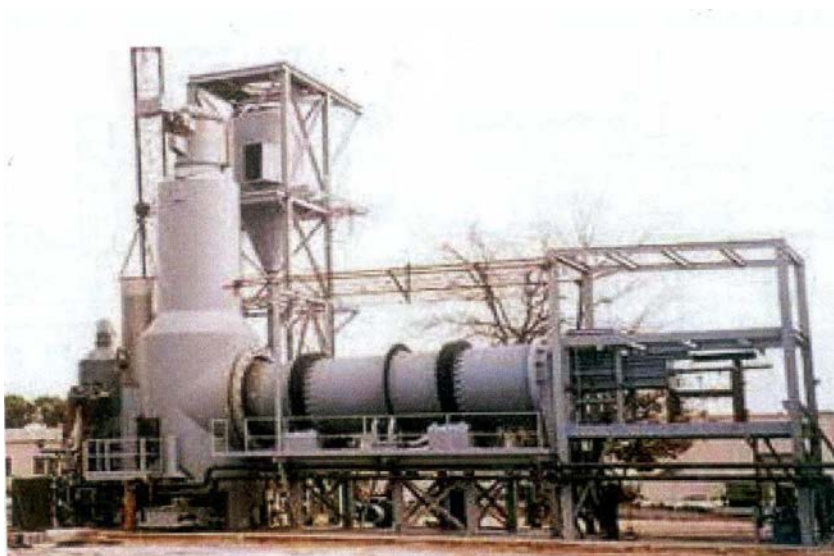
ภาพที่ 6.6 ระบบเตาเผาแบบหมุนที่ติดตั้งใช้งานจริง ที่มา : http://bangkokgreencity.bangkok.go.th
