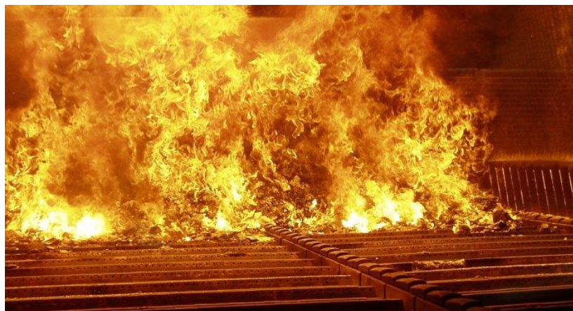
รูปที่ 3-15 ห้องเผาของเตาแบบตะกรับเคลื่อนที่ ที่สามารถจัดการกับเศษวัสดุ 15 ตันต่อชั่วโมง ที่มา : https://th.wikipedia.org
